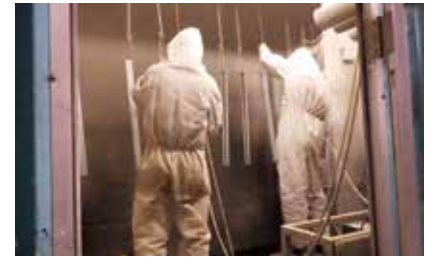
自動機ラインでの海外実習生の補正塗装
